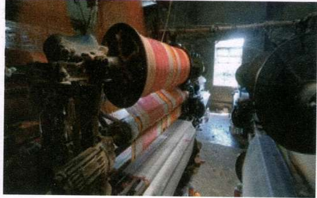
চিত্র-১০: গ্রাউন্ড ও পাইল বিম তাঁতে স্থাপন।
