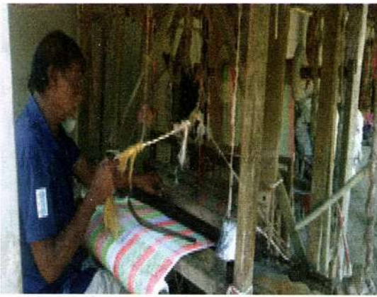
চিত্র-১২: হেঁম তাঁতে তোয়ালে উৎপাদন।
